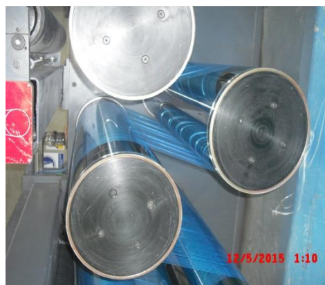
Proceso de estirado los tambores de color negro estiran la película (cinta).
