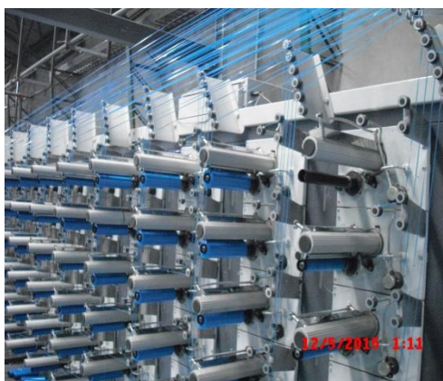
Bobinadoras enrolladoras de cintas de polipropileno con diámetro de 3,2 mm.
